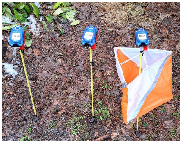
Fig. 8. De drie SI stations bij start en finish. Op volgorde van gebruik van l. naar r.: de Clear , midden de Start en rechts de Finish . Soms wordt tussen Clear en Start ook nog de Check geplaatst. In de praktijk wordt dit niet altijd gedaan.
