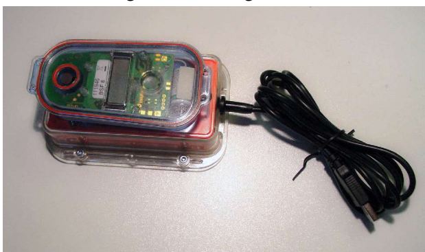
Fig. 65. De koppeling van een nieuw station via een ferritstaafje met de PC via een station met USB aansluiting.
